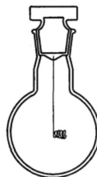
图 2 带有连接在瓶塞口铂丝的氧燃烧瓶实例(用于方法 B)
